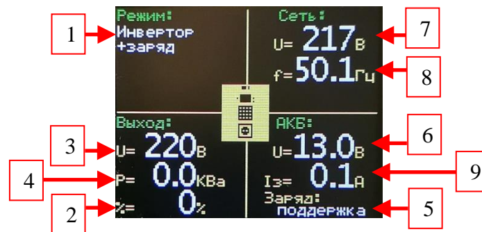
Рис.№2. Индикатор в режиме отображения электрических параметров.
